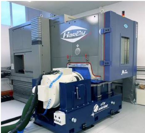
恒温槽付き振動試験機
