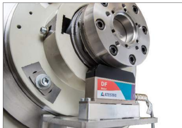
ダイナモにトルク計を直結した使用例
