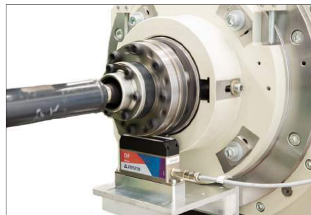
ダイナモにトルク計を直結した使用例
