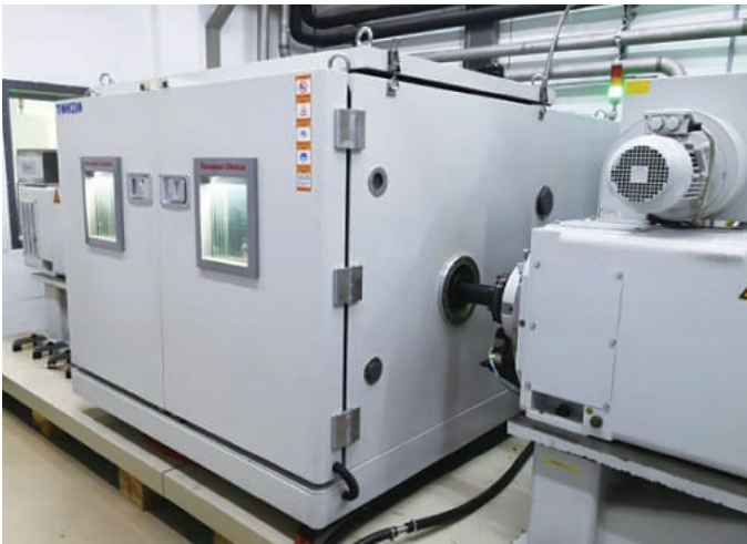
恒温槽付き2軸負荷ダイナモ試験機
