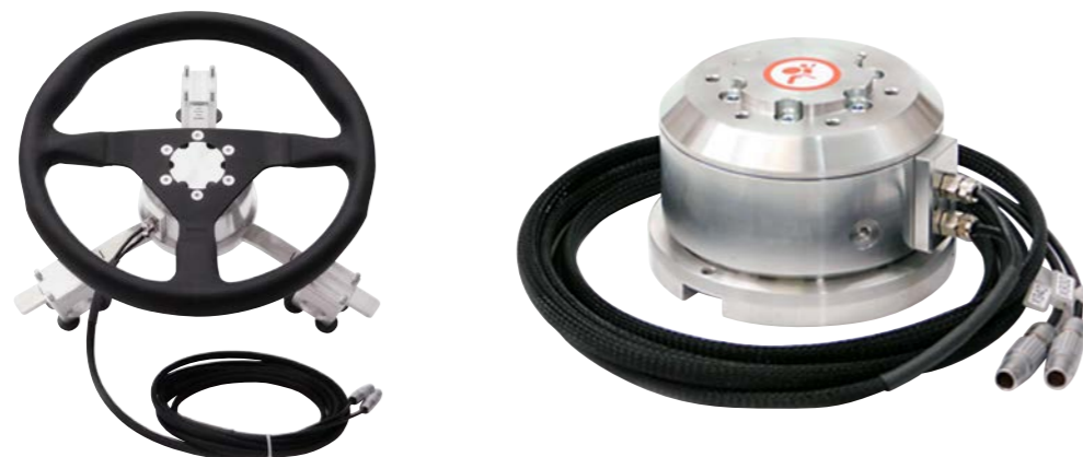
オリジナルのハンドルに装着して操舵力と操舵角を計測
